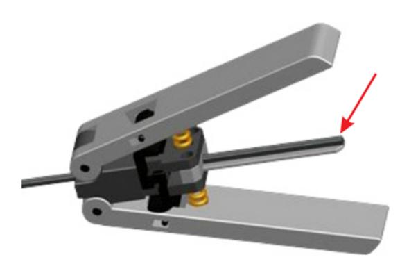
**5.3** - Insira o núcleo óptico no perfil interno do Gabarito, na posição "deitado", até o final da marcação indicado pela seta.
