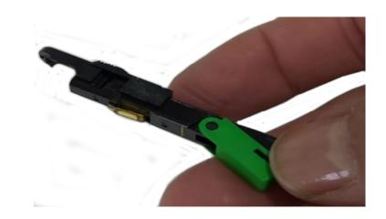
**6.7 -** Retire o núcleo óptico do Conector, de forma cuidadosa, para evitar a quebra da fibra dentro do Conector, preservando a sua reutilização.
