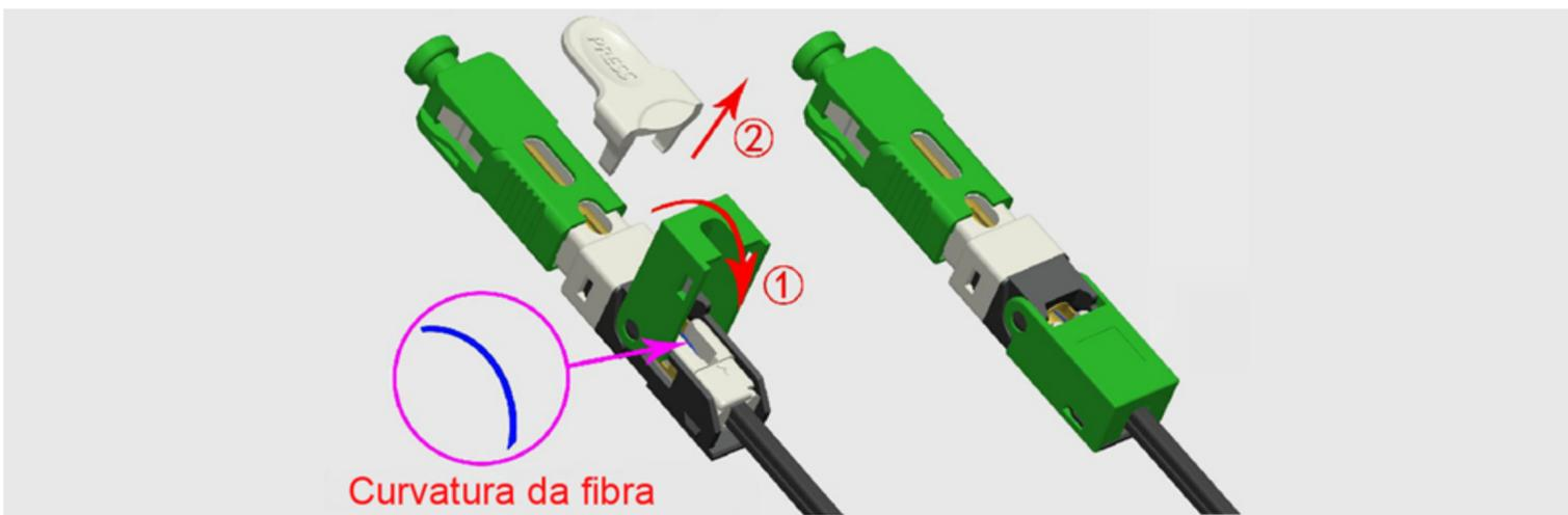
5.17 - Retire a tampa frontal do ferrolho e com a caneta de limpeza limpe resíduos que possam interferir na conexão óptica antes da utilização do conector de campo.
