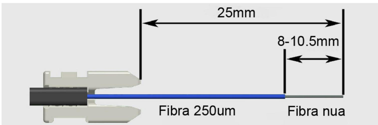
5.13 - Abra a tampa traseira do conector, pressione o acessório de travamento e insira a fibra dentro da câmara na parte de trás do conector até o limite, utilizando o Alinhador.
