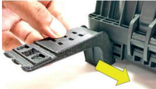
**4.5.1** Encaixe os suportes poliméricos para cordoalha no encaminhamento tipo “fêmea” da base da CTO-C, empurrando-o até o “clique” da trava de segurança (na cor azul).
