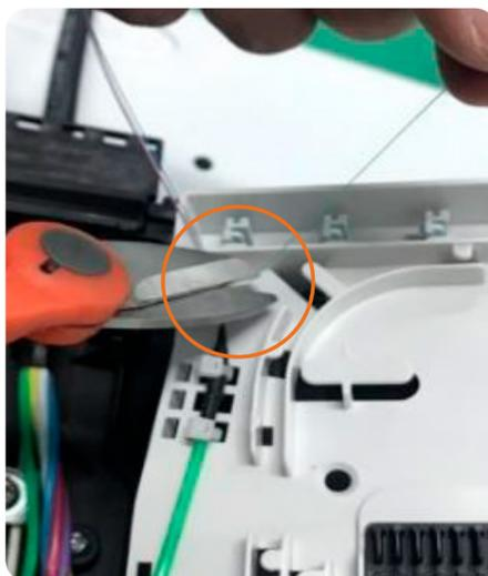
**2.** Cortar a fibra alimentadora do lado inferior da bandeja.
