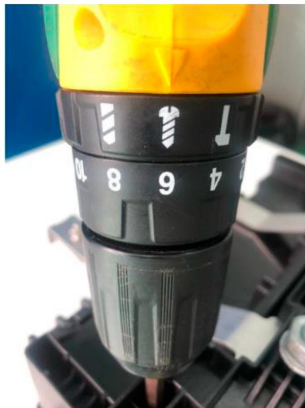
**Observação:** Para uso de parafusadeiras na fixação do suporte com a base da caixa ajustar o torque não superior a "6".
