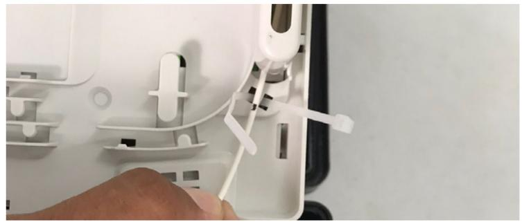
3. Fixar o Pig-Tail no módulo com uma abraçadeira;
