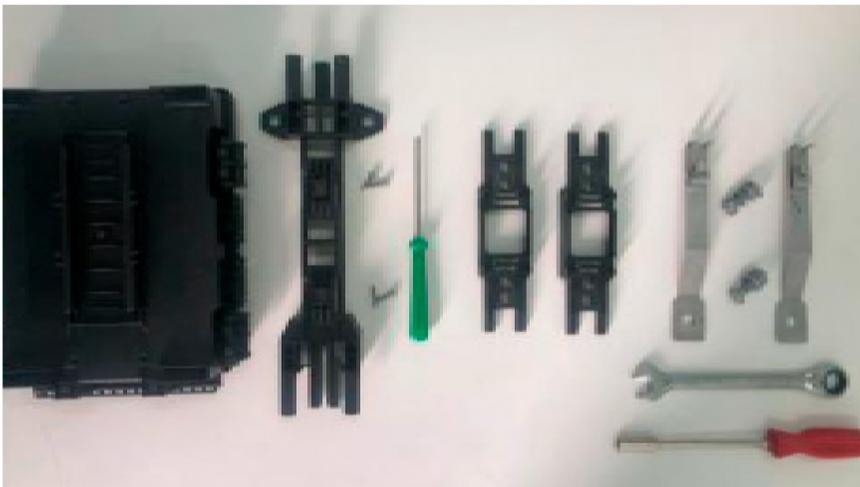
**Observação:** Para uso de parafusadeiras na fixação do suporte com a base da caixa ajustar o torque não superior a "6".
