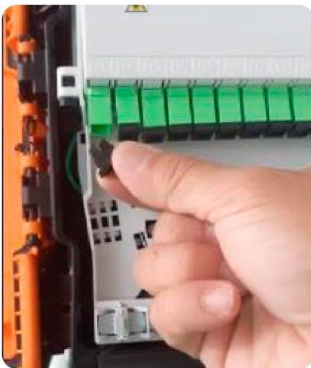
**1.** Retire a tampa de proteção do adaptador para medir a potência óptica conforme slide anterior;
