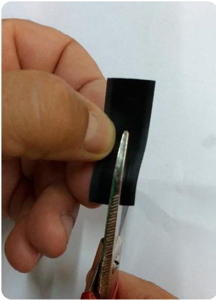
1. Corte a fita com uma altura de 5 cm.
