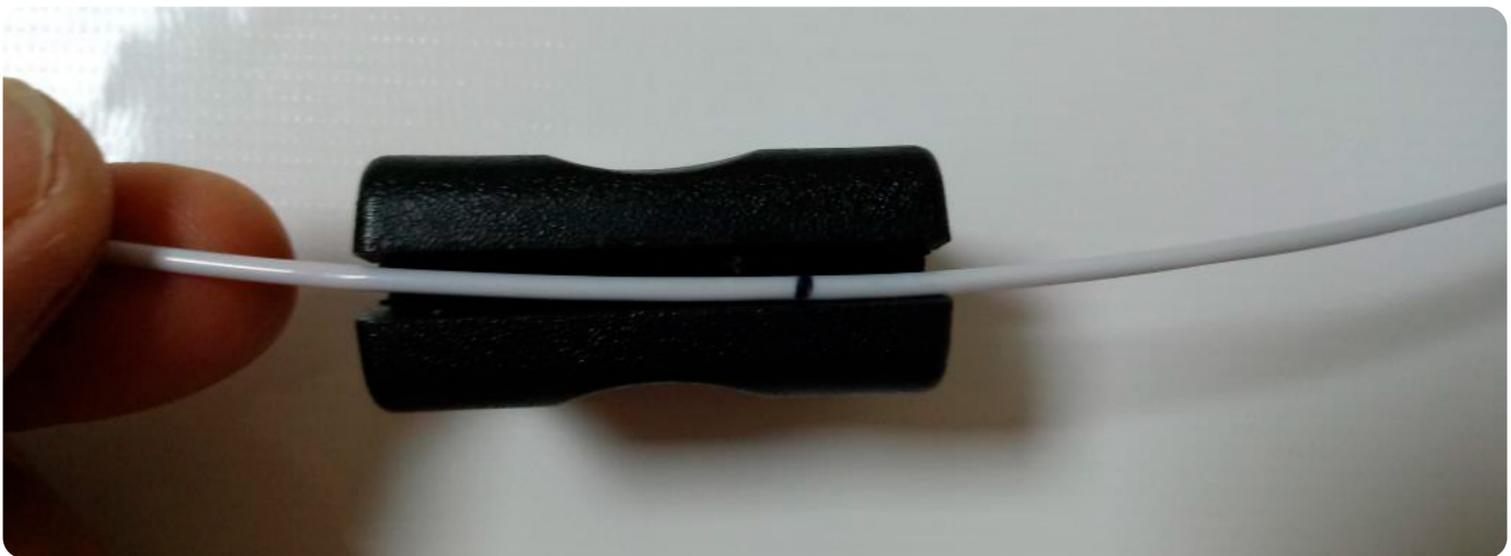
Iniciar o processo de abertura do tubo com a ferramenta apropriada para derivação da fibra (abridor longitudinal de tubo loose).
