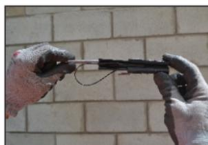
**2.2.** Na instalação do drop, acomode primeiro o NÚCLEO no drop e em seguida o CORPO, deslizando até o CORPO no sentido do NÚCLEO.
