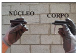
**2.1.** O SRDO é composto por três partes, NÚCLEO e CORPO unidos pelo Cordão plástico e GANCHO METÁLICO..
