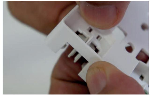
4. Coloque a trava no local que será utilizado para a entrada do drop. (Fig. 9)
