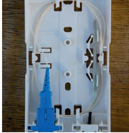
Confeccione a emenda por fusão e acomode o protetor termocostrátil no compartimento.
