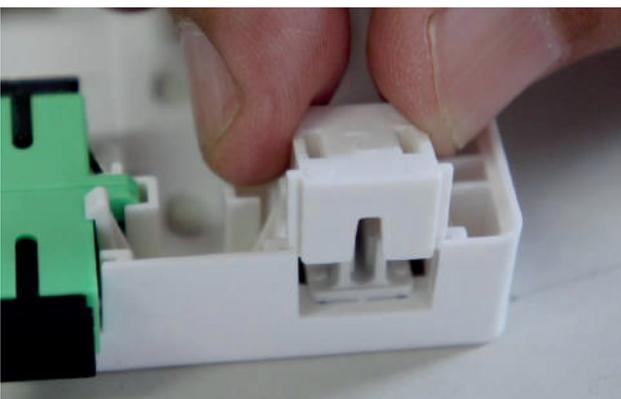
3. Acomode do drop óptico montado na trava de fixação do PTO. (Fig. 3)
