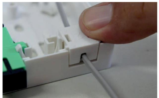
5. Feche o PTO colocando a tampa e aperte o parafuso. (Fig. 5)
