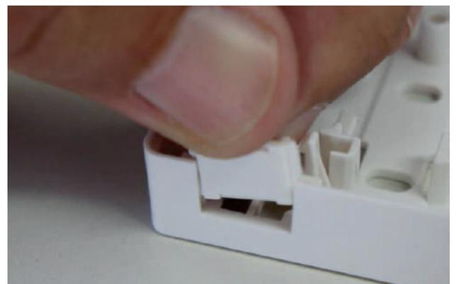
6. Acomode o drop óptico montado na trava de fixação. (Fig. 11)
