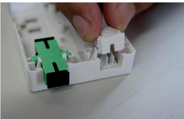
3. Retire o compartimento de fixação do drop, pressionando-o pela parte posterior. (Fig. 8)
