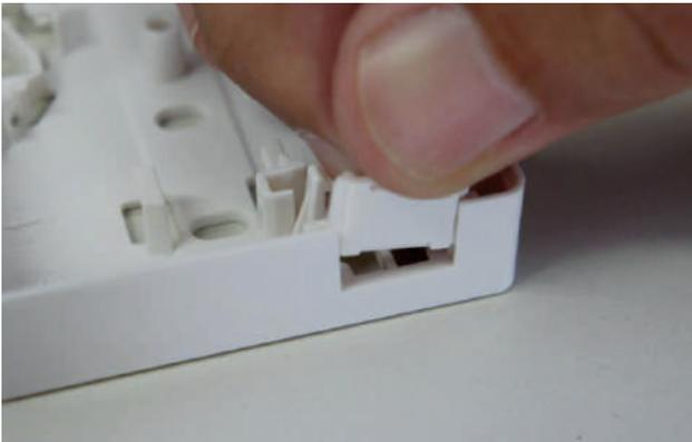
2. Retire a tampa da trava do compartimento de fixação do drop. (Fig. 7)
