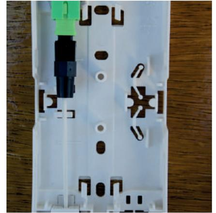
Confeccione a conectorização do drop óptico, coloque-o no adaptador e fixe-o com a trava do drop.
